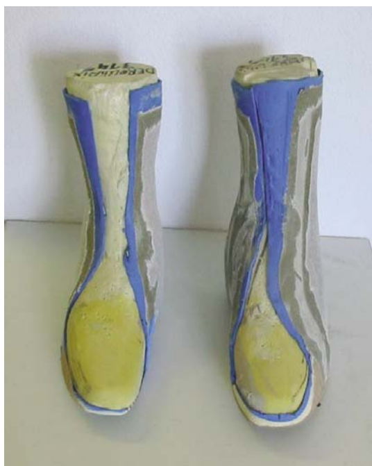
Figura 5 Positivo realizado en resina después del moldeo y colocación de los futuros elementos de contención.
