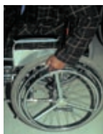
11 Propulsión de una silla de ruedas con doble pasamanos.
