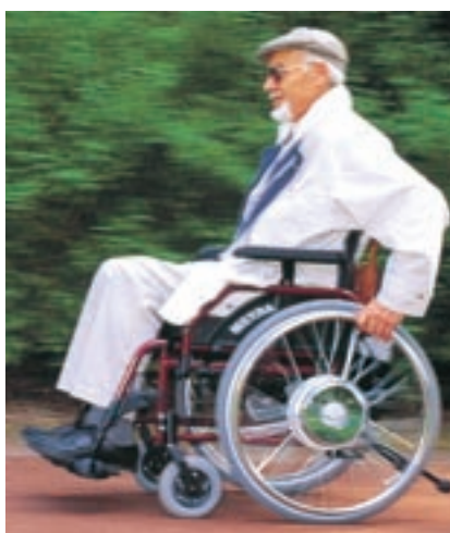
21 Silla de ruedas manual con ayuda eléctrica para la propulsión.
