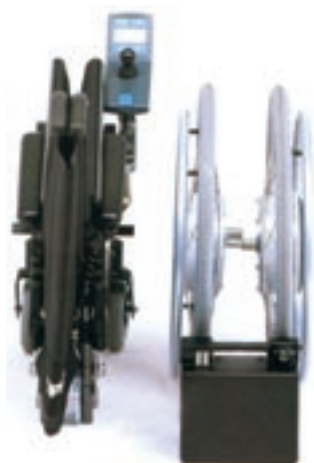
20 Silla de ruedas manual con dispositivo de propulsión por motor eléctrico (desmontada).
