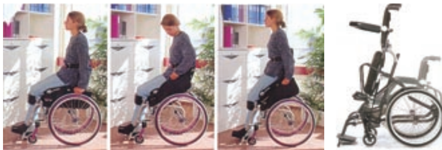
29 Silla de ruedas manual con verticalización manual asistida.
