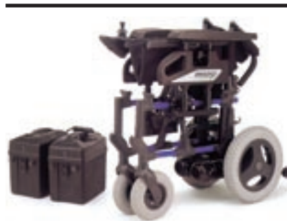
17 Silla de ruedas eléctrica con chasis plegable (desmontada).
