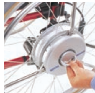
22 Ruedas traseras con motor de asistencia eléctrico.
