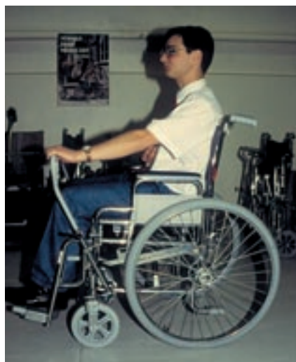
9 Silla de ruedas con palanca pendular para personas hemipléjicas.
