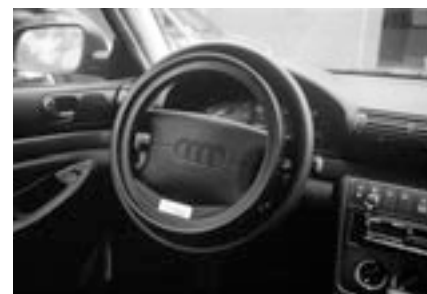
6 Mando circular (acelerador y freno eléctrico).
