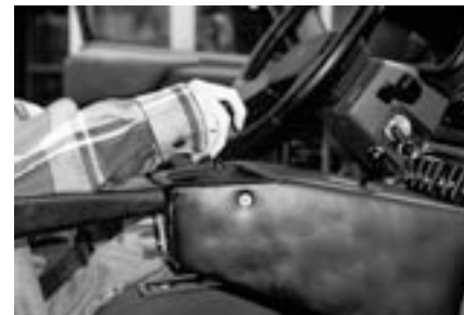
7 Conducción de un tetrapléjico con minipalanca de mando.
