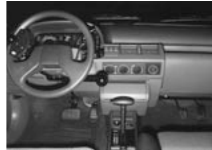
5 Acelerador y freno por palanca. Empuñadura en el volante y agrupamiento de los principales mandos.
