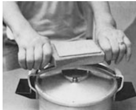
18 Las dificultades al abrir una olla a presión pueden evitarse mediante una ayuda técnica de palanca.
