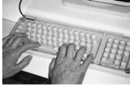
6 El guiadedos, colocado sobre el teclado de un ordenador o una máquina de escribir, evita que se pulsen varias teclas con un solo dedo. Frente a los problemas de coordinación de los miembros superiores, constituye una ayuda apreciable en los terrenos de la comunicación, del ocio e incluso del trabajo.
