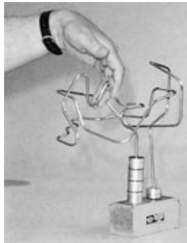
2 El instrumento de Moede: el paciente debe deslizar una arandela de un extremo a otro del alambre metálico. Esta prueba cronometrada es fácilmente cuantificable pero polifactorial.
